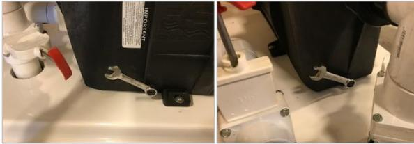
Réinstaller les 2 bouchons de drainage à la base de la pompe.
