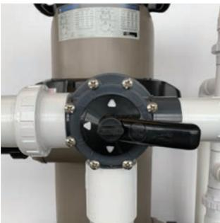
Ensuite, positionner le levier de la valve à trois voies en position de drainage.
